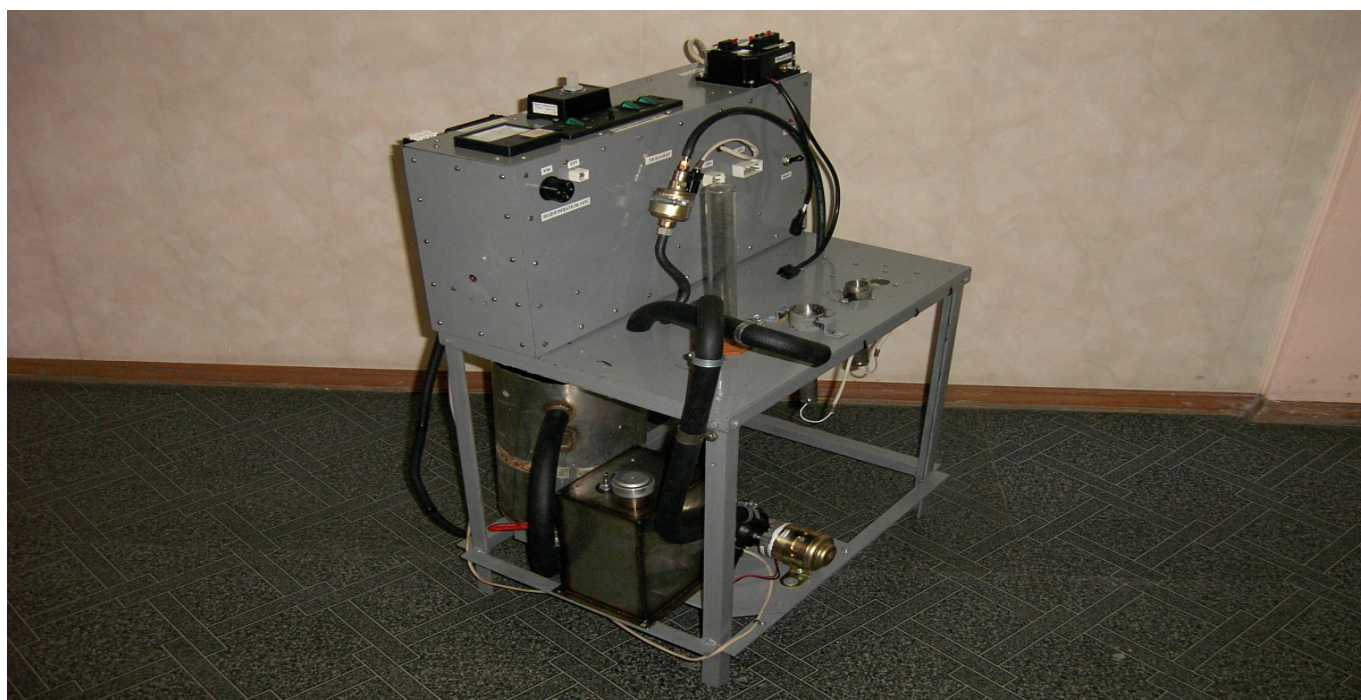
Рис. 23 – Стенд контроля подогревателя 14ТС
